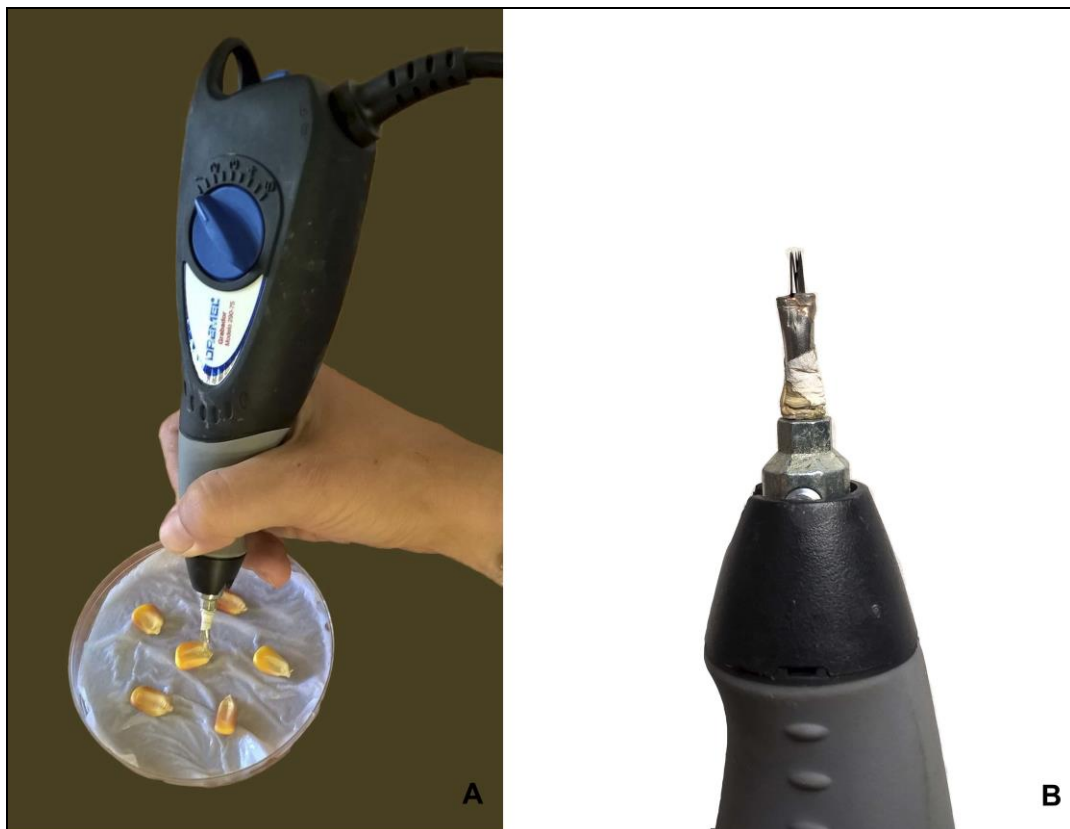
Fig. 15. Instrumento utilizado para realizar la inoculación de maize yellow stripe virus mediante la técnica de incisiones vasculares de semillas de maíz. A) Vista general de la herramienta. B) Detalle de la punta con peine de dientes finos.
