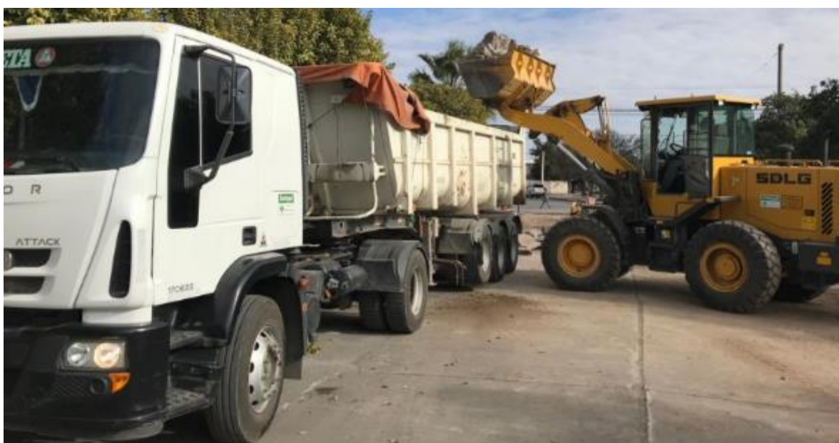
Figura 14. Pala frontal cargando batea
