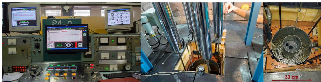
**Figura 2.1:** Consola de control principal del Reactor Nuclear RA-0 (izquierda), núcleo del reactor en donde se pueden observar las cuatro barras de control y el soporte para la irradiación de muestras (centro) y vista superior del núcleo en donde se indica el diámetro exterior del mismo (derecha).
