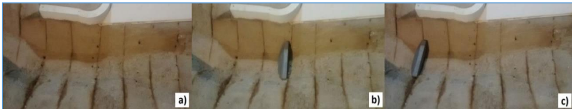
Figura 38. Configuraciones a analizar para cada caudal: a) Sin Azud, b) con Azud en posición A, y c) con Azud en posición B. Se agregan, además, para la condición b) y la condición c) un azud de altura mayor, conformando las configuraciones d) y e) .
