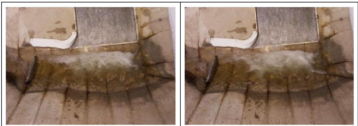
Figura 55. Flujo en el cuenco amortiguador para la condición Azud B alto .
