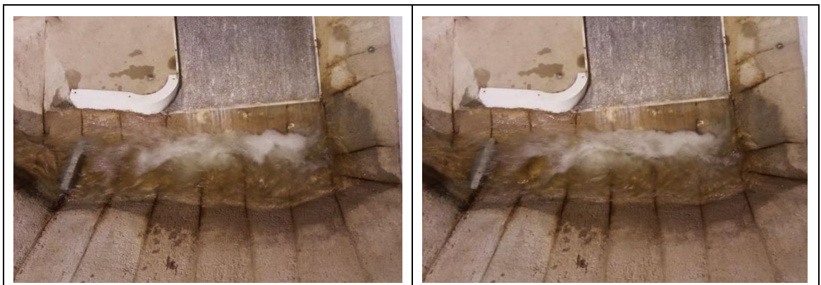
Figura 54. Flujo en el cuenco amortiguador para la condición Azud B bajo .
