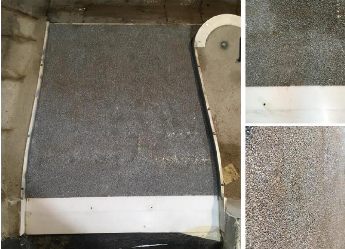
Figura 31. Rápida del vertedero con arena ( d_{50} :2mm).
