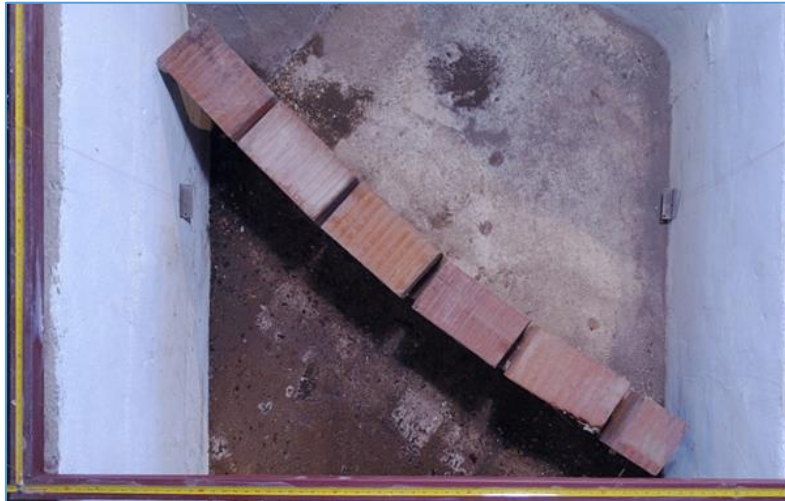
Figura 26. Deflector constituido de ladrillos cerámicos huecos.
