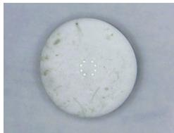
Figura 2.12: Gota observada con el microscopio digital. Las manchas que se observan son las partículas de material vegetal, suspendidas en el agua ultrapura.
