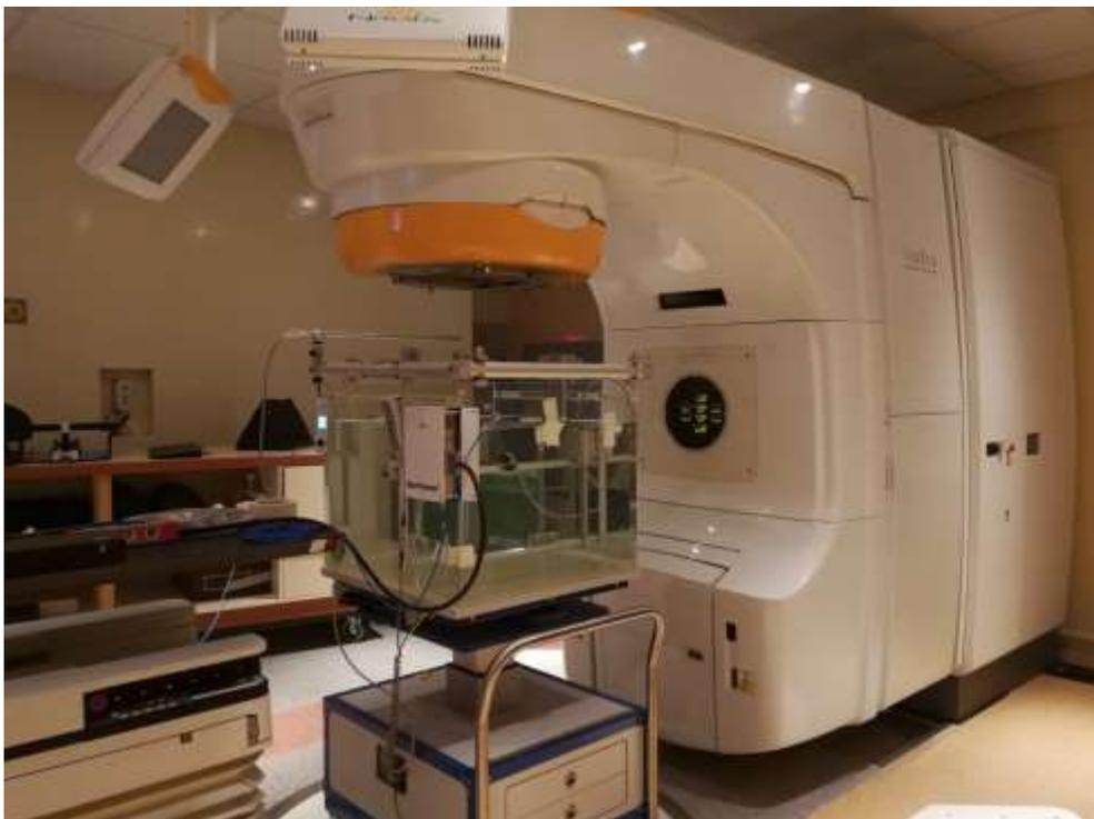
**Figura 10.** Montaje experimental linac-fantoma.
