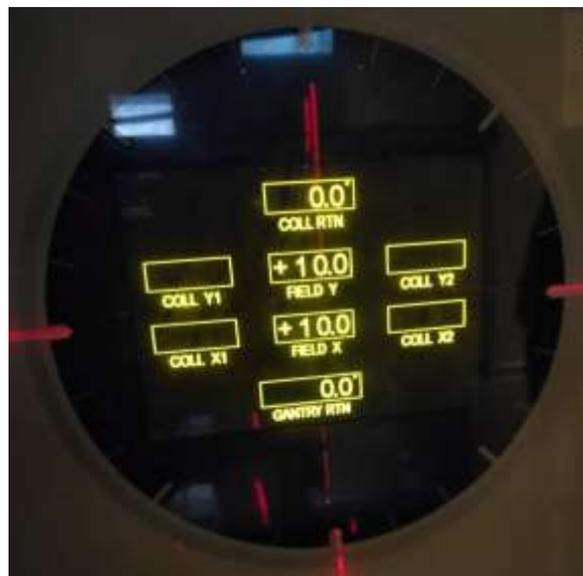
**Figura 13.** Configuración para gantry y campo  $10 \times 10 \text{ cm}^2$  (Field X-Field Y).
