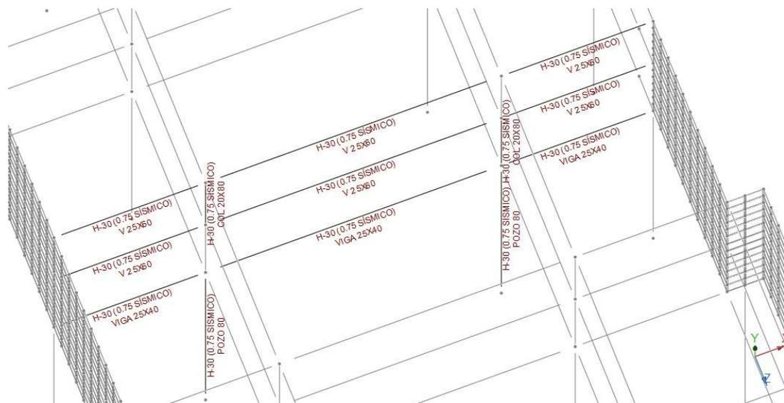
Figura 4.5 - Asignación de secciones y materiales
