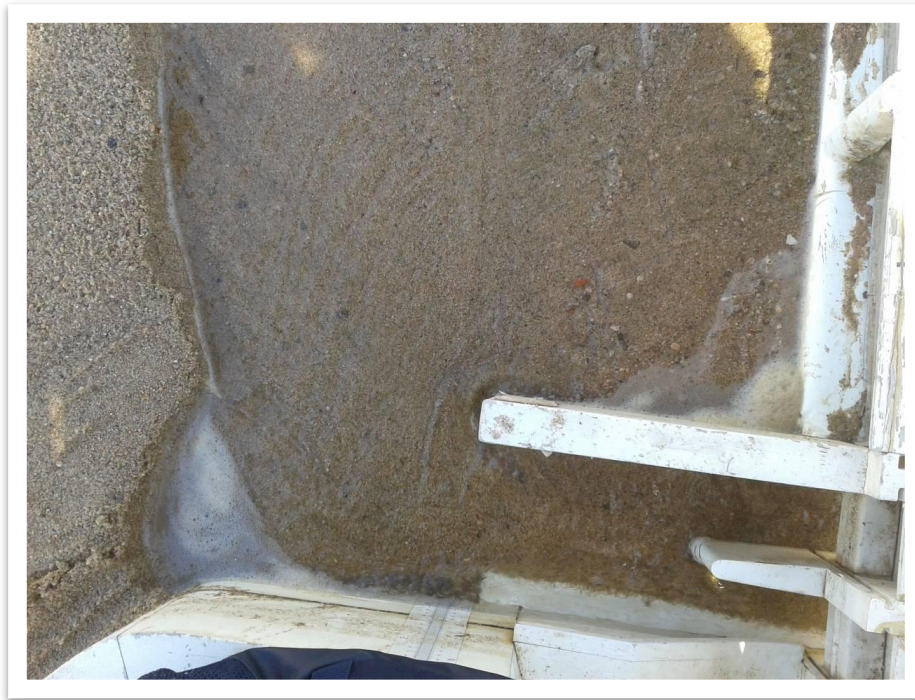
Figura 57: Detalle de zona aguas arriba de la obra con Q=50 \text{ m}^3/\text{s}
