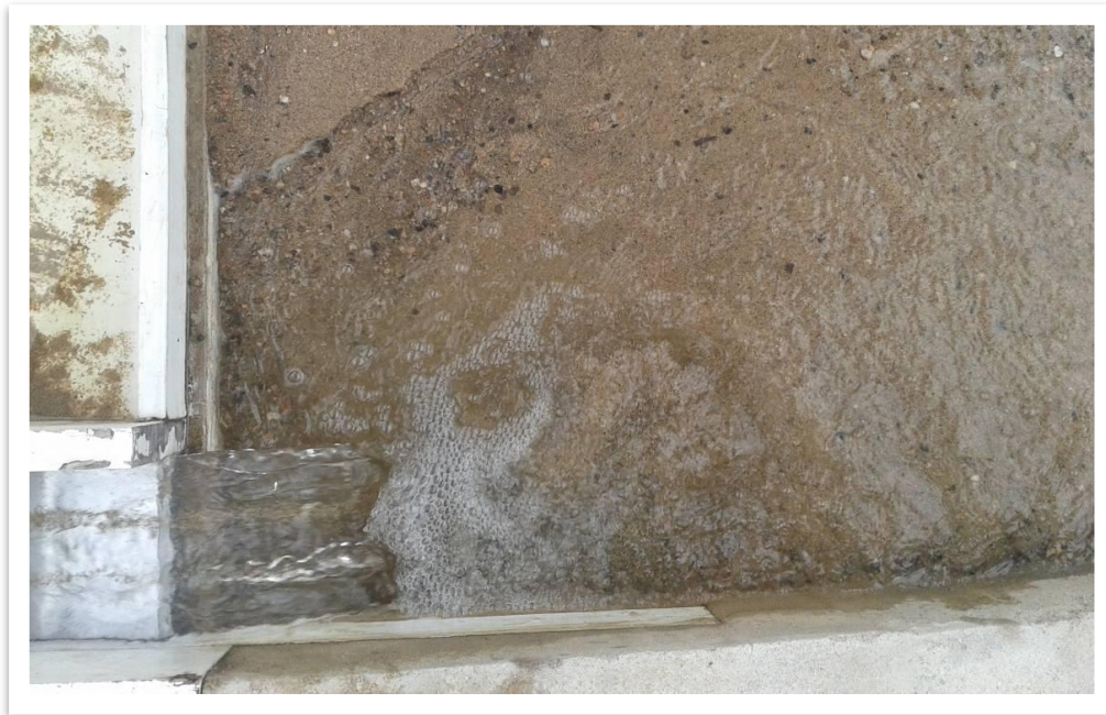
Figura 77. Fosa de erosión aguas debajo de CM con Q=150 \text{ m}^3/\text{s}
