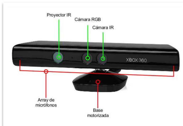
Figura 18: Cámara RGB-D Kinect Microsoft. (Adaptado de Wikipedia, 2012).
