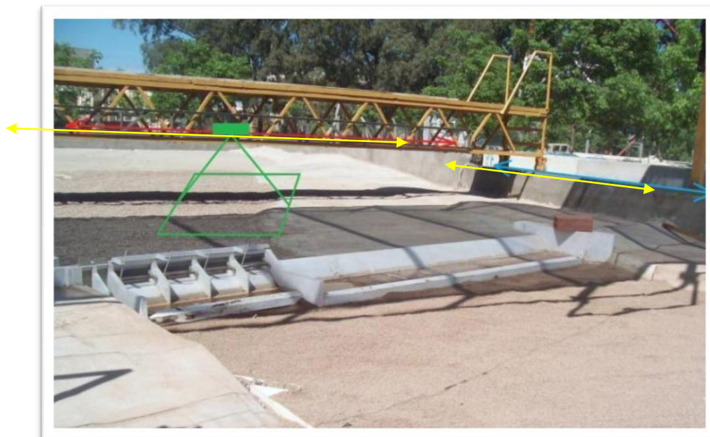
Figura 10. Guía soporte para la cámara RGB-D (LH, 2012 y Bellino, 2013).
