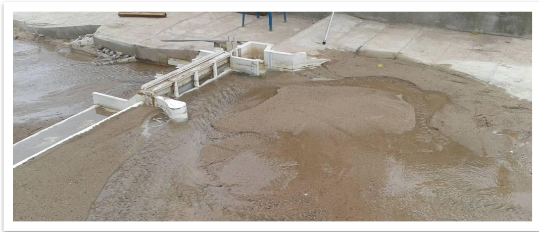
Figura 69: Detalle de zona aguas arriba de la obra con Q=100 \text{ m}^3/\text{s}
