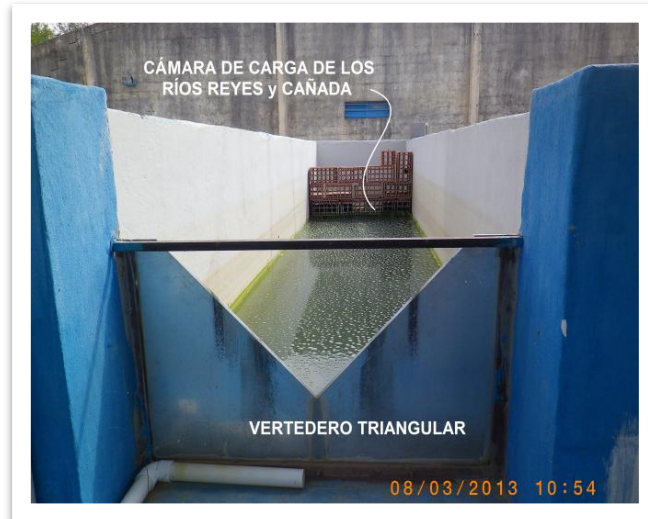
Figura 11: Cámara de aforo del modelo físico.
