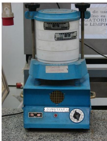
Foto 6. Vibrador con tamices
