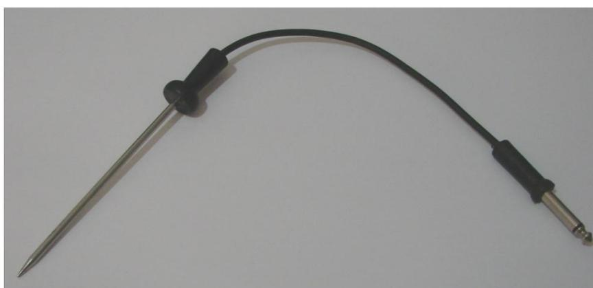
Foto 8. Sensor de temperatura del microondas
