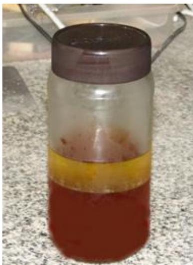
Foto 23. Frasco para la extracción con butanol (capa superior)
