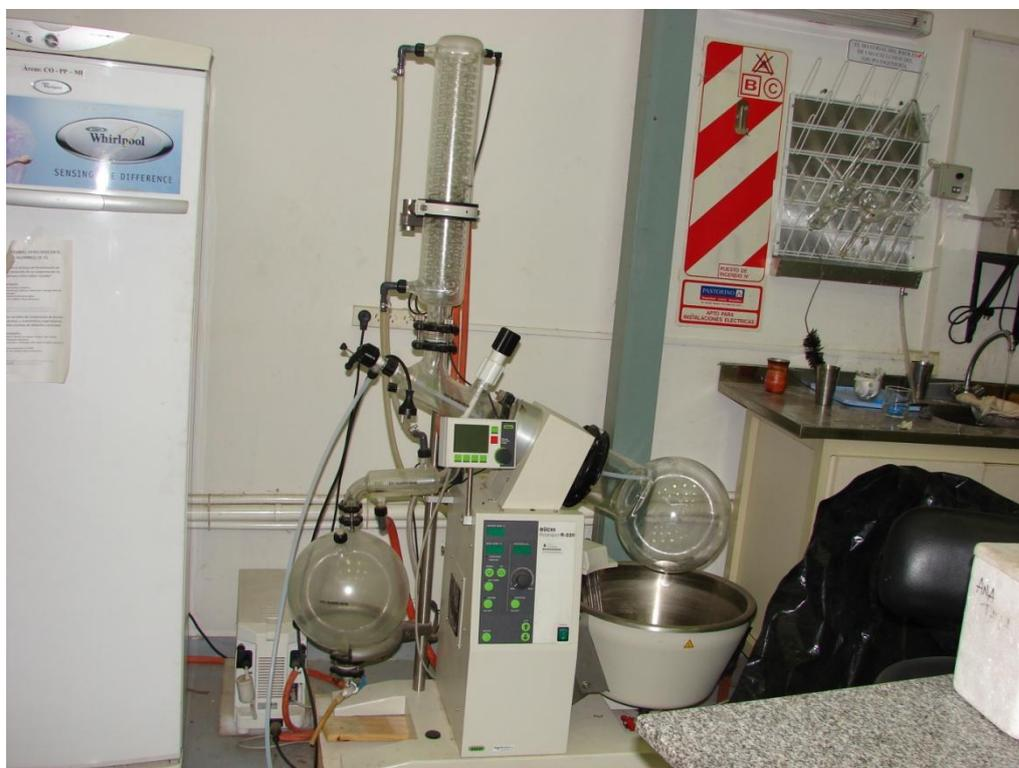
Foto 19. Evaporador rotatorio escala piloto marca Buchi
