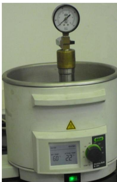
Foto 18. Reactor en el baño termostático
