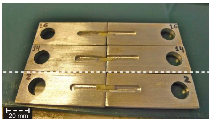
Fig. 25. Colocación de bastones en canaleta central.
