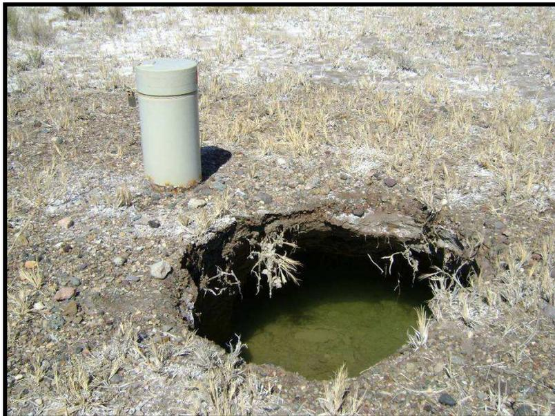
Figura 37: Vista de un pozo “volcán” generado por la disolución por escorrentía subterránea. La napa freática se encuentra a 43 cm de profundidad.
