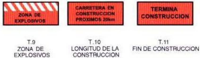
Fig.13.7 – Cartelería de Zonas de Riesgo.
