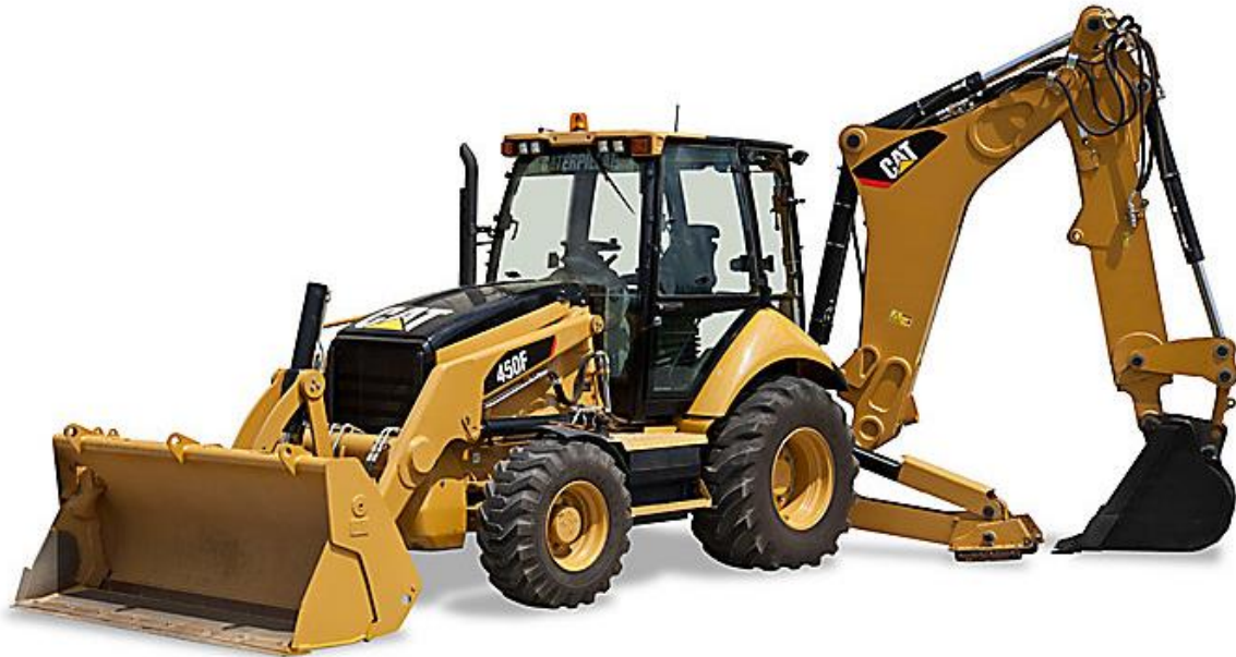
Fig.6.33 – Retroexcavadora CAT 416e.
