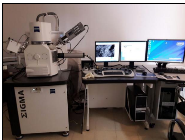
Fig. 2.24: Microscopio electrónico de barrido Carl Zeiss Sigma FEG del LAMARX-FaMAF-UNC.
