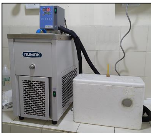
Fig. 2.7: Sistema de enfriamiento (SE-1) utilizado para la síntesis de MAPs por AD.
