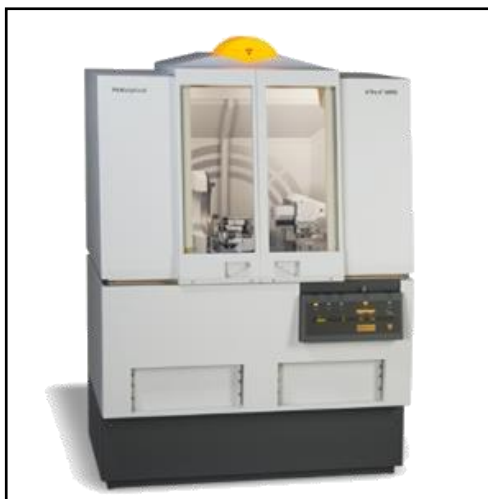
Fig. 2.25: Difractómetro de rayos X PANalytical X'pert Pro del INFIQC-FCQ-UNC.
