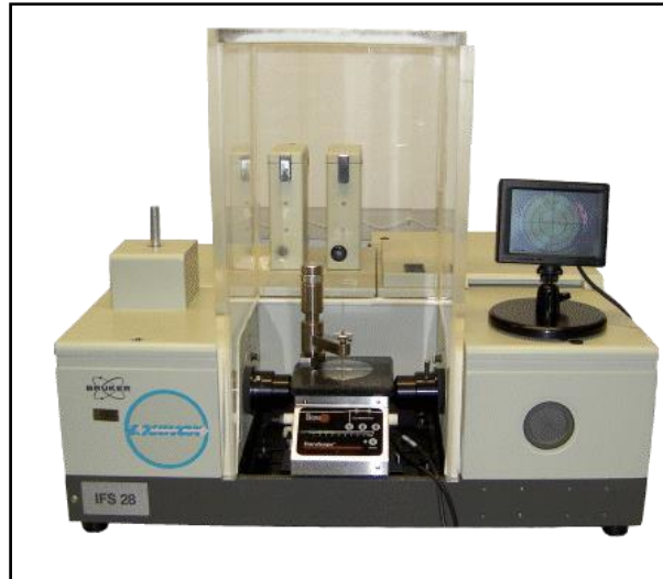
Fig. 2.27: Espectrómetro IFS 28 FT-IR Bruker del INFIQC-FCQ-UNC.
