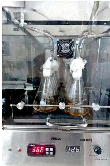
Figura 4. Equipo para incubación con CO<sub>2</sub>
