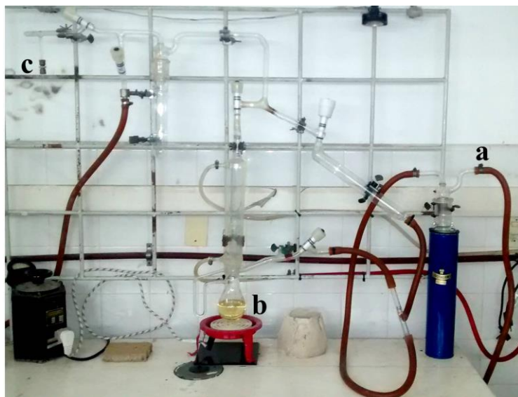
Figura 2.1 – Fotografía de la línea de vacío utilizada para evacuación de ampollas para reacciones de síntesis elemental. a) Conexión a bomba de vacío mecánica. b) Bomba difusora de aceite. c) Tubo y conector para acople de ampollas.
