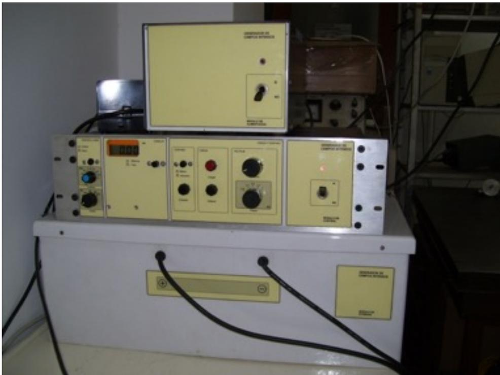
Figura 4.10: *Equipo GCM, de abajo hacia arriba: módulos de potencia, de control y de alimentación.*
