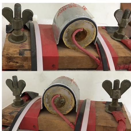
Figura 4.8: *Bobina generadora de campo magnético.*
