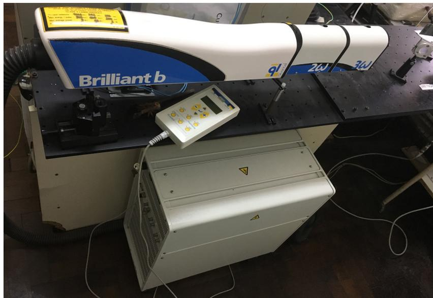
Figura 4.7: *Láser de Nd:YAG utilizado como fuente de excitación para experimentos resueltos en el tiempo.*
