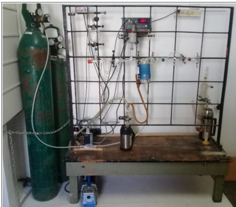
Figura 4.2: Sistema de Vacío construido por líneas de Vidrio pyrex
