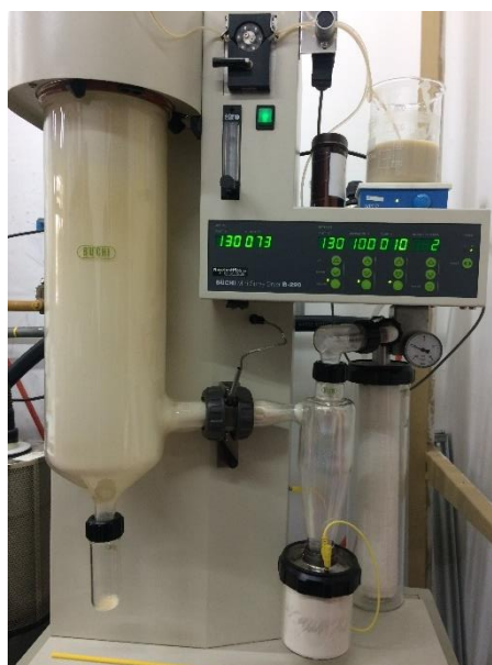
Figura 9. Secado por aspersión utilizando Mini Spray Dryer Büchi B-290
