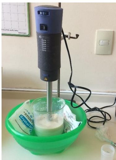
Figura 8. Preparación de la emulsión utilizando el homogeneizador Ultraturrax
