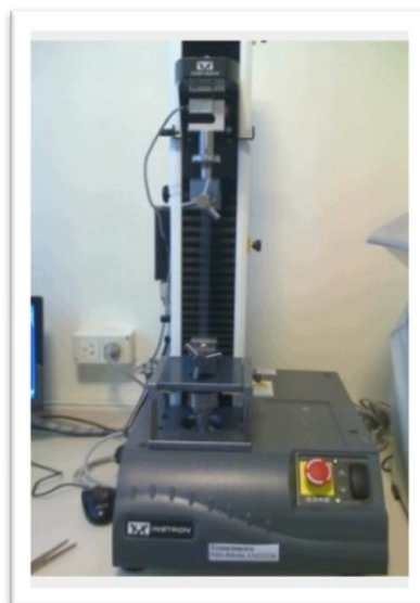
Figura II.2.3.1. Fotografía del instrumento de testeo universal utilizado.
