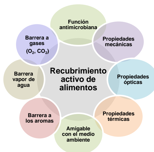
Figura VIII.3.3.1. Propiedades que necesitan ser satisfechas para el desarrollo de un recubrimiento activo de alimentos
