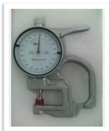
Figura II.2.2.1. Fotografía del micrómetro utilizado para la determinación de los espesores de las películas
