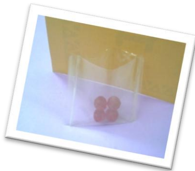
Figura VII.1. Fotografía de película SPI-PLA 60/40 termo-sellada en sus extremos para formar una bolsa.
