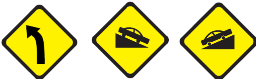
Figura 32: Señales de curvas horizontales P-7 y Pendientes P-9
