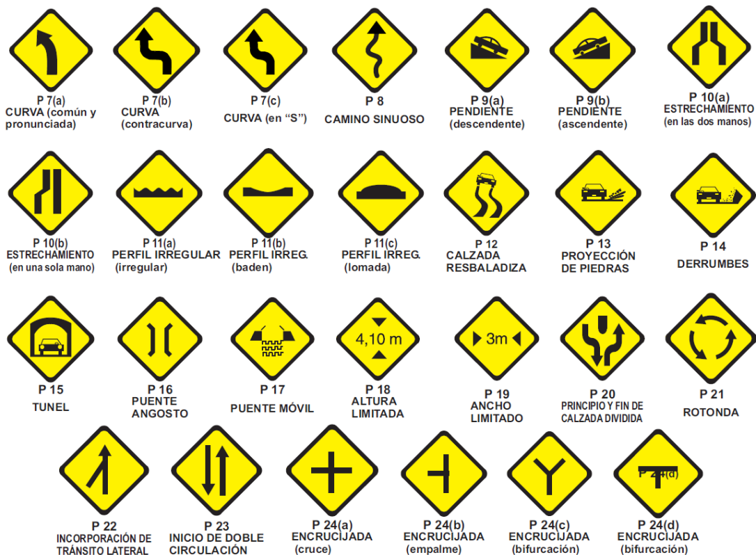
Figura 12: Señales de advertencia sobre características de la vía
