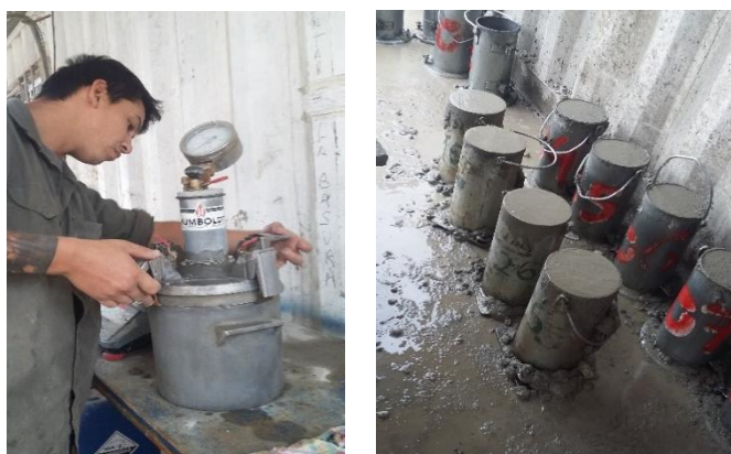
Figura 8: Vacíos en el hormigón y moldeo de probetas
