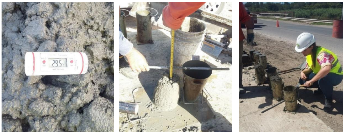
Figura 12: Temperatura, asentamiento y moldeo de probetas de hormigón.
