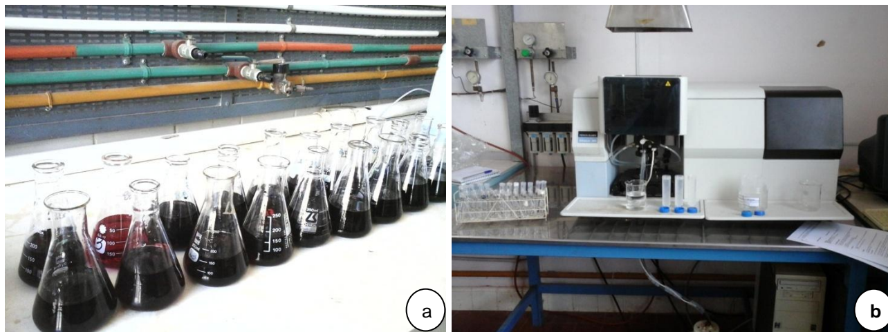
Fig. 7. Técnicas de análisis para componentes de yema en huevos de Phrynos hilarii : a-Kjeldahl (proteínas), b-Absorción atómica (Ca, Mg, Fe y Zn)
