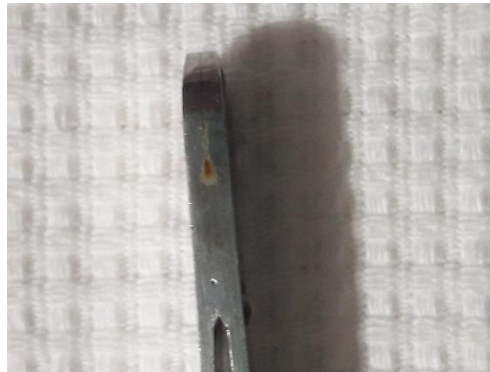
Figura 12: Presencia de corrosión en pinza de disección con dientes origen pakistaní.
