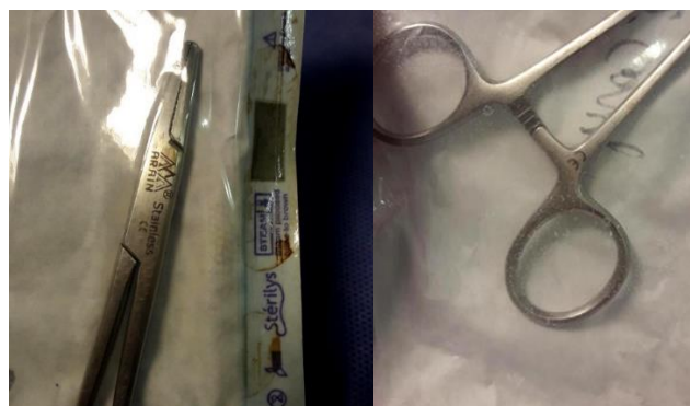
Figura 13: Presencia de impurezas en la superficie del papel pouch luego de la esterilización.
