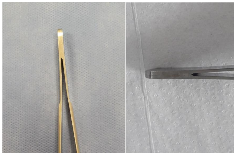
Figura 11: Comparación del cambio de coloración de la pinza de disección (pakistani) luego del ensayo.
