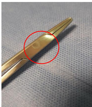
Figura 14: Presencia de impurezas en la superficie de la pieza luego de la esterilización
