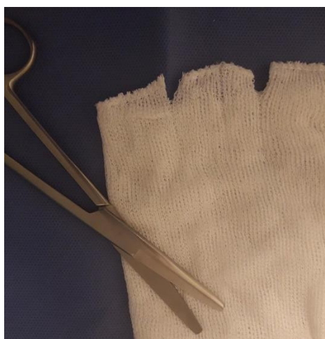
Figura 9: Resultado de test de corte marca pakistani, con compresa de gasa después de 100 procesos.
