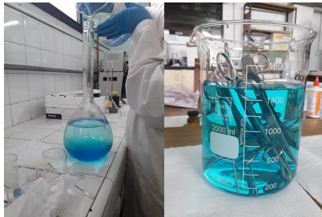
Figura 6: Inmersión del instrumental en la solución de Sulfato de Cobre.
