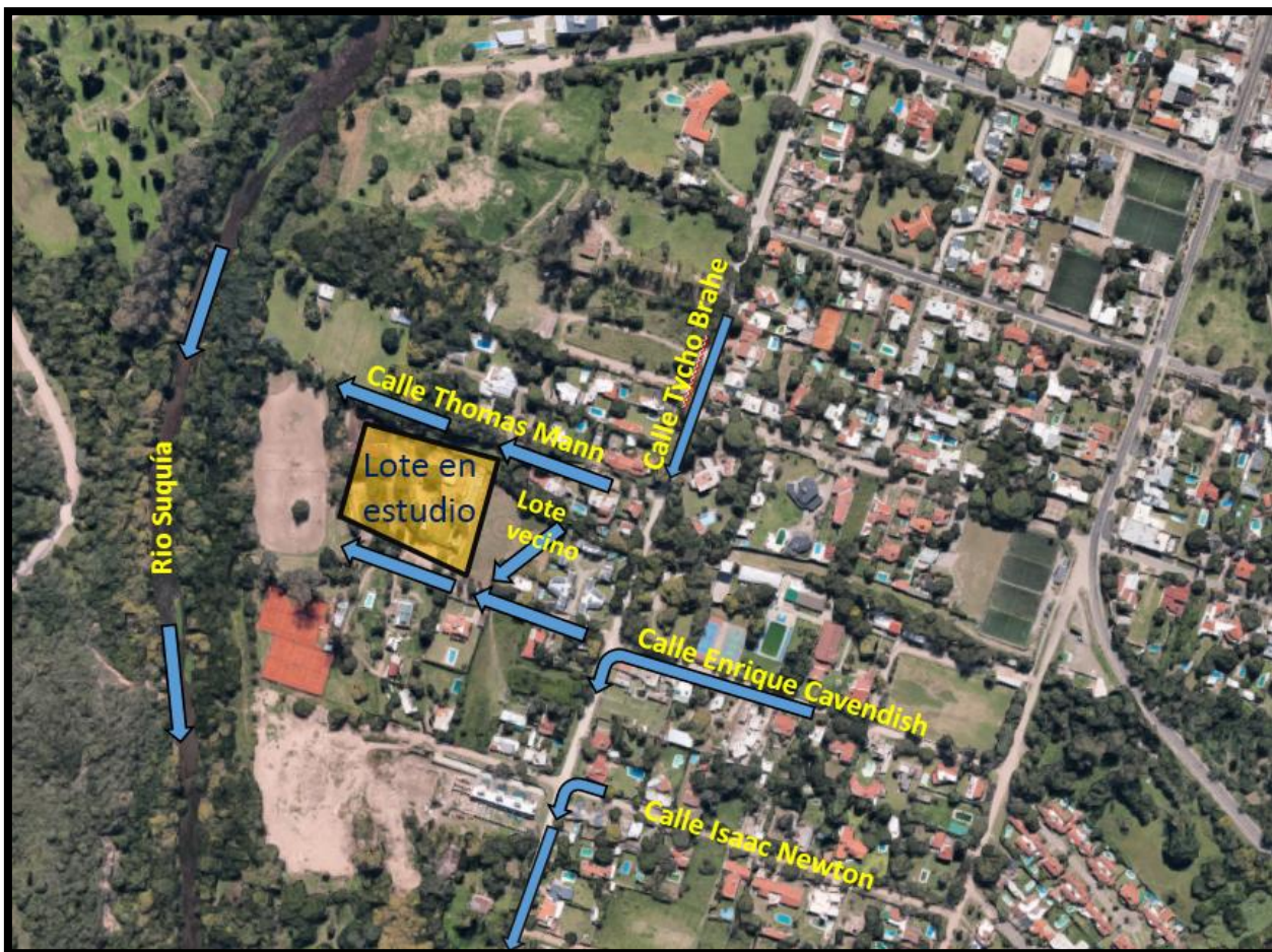
Figura 6.1. Representación esquemática de las líneas de escurrimiento en las zonas aledañas al lote en estudio.
