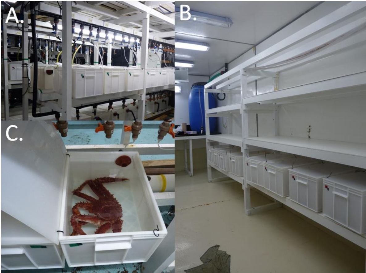
Figura 2.3. Sistema de acuarios de trabajo donde se realizaba la aclimatación y reperusión (A). Cámara fría donde se realizaba la exposición aérea a una temperatura controlada (B). Acuarios individuales donde se ubicaban las centollas (C).
