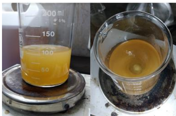
Figura 34: Agitación magnética durante la deshidratación con CaO.
