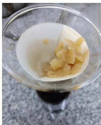
Figura 24: Filtración de la mezcla con sulfato de sodio hidratado.
