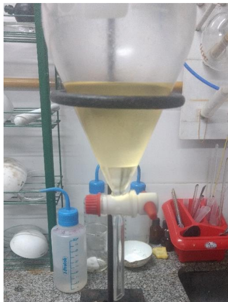
Figura 37: Separación de fases en la deshidratación con hexano.
