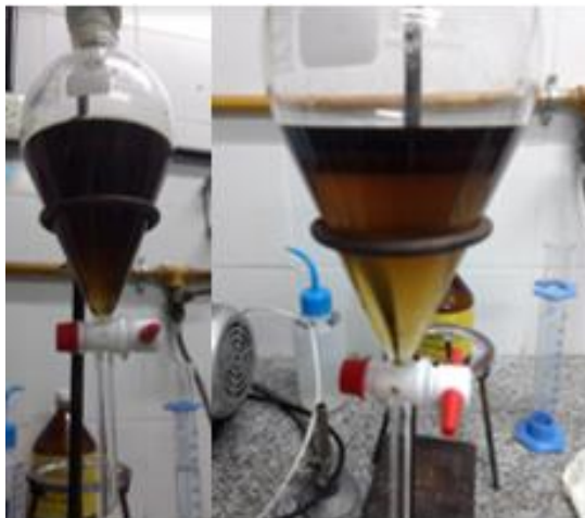
Figura 20: Primer y segundo lavado con agua.
