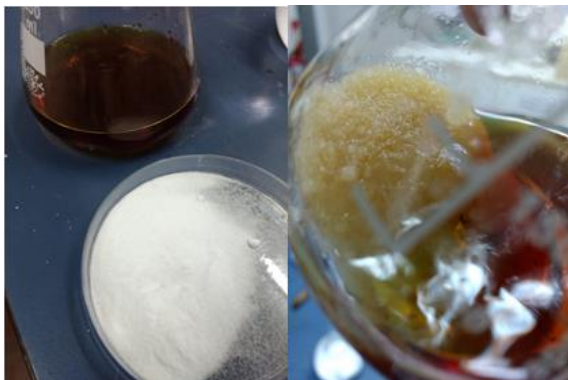
Figura 23: Secado con sulfato de sodio, a la izquierda sulfato seco, a la derecha sulfato hidratado.
