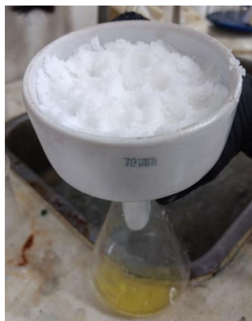
Figura 40: Filtración de la mezcla de fusel con \text{Na}_2\text{SO}_4 hidratado.
