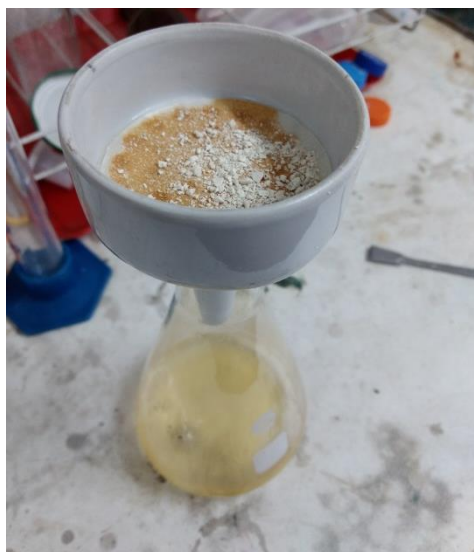
Figura 35: Filtración de la mezcla de fusel con CaO hidratado.
