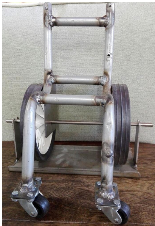
Figura 5: Estructura silla de ruedas sin pintar.
