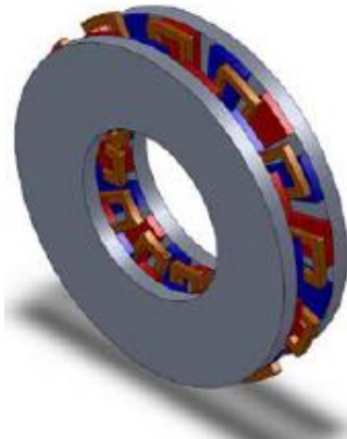
Figura 2.12: Máquina N-S estator sin núcleo interior.
