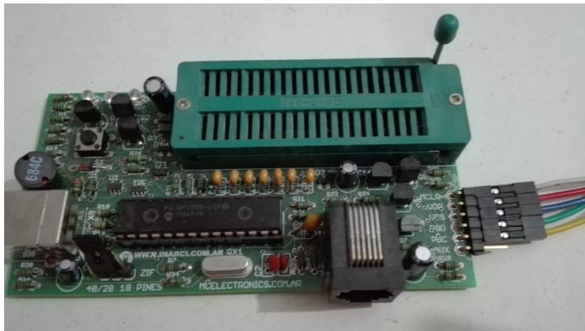
Figura 5.6: Placa de programación puerto ICSP
