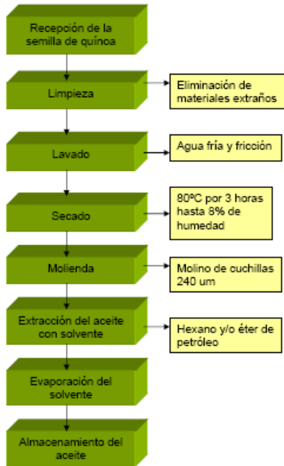
Figura 3. Diagrama de bloques del proceso de extracción de aceite de quinua (13) .
