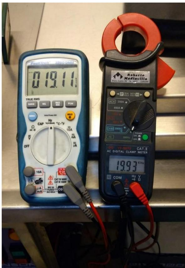
Fig. 30: Multímetro y pinza amperometrica. Tomado de: Central de Esterilización – Hospital Municipal de Urgencias.
