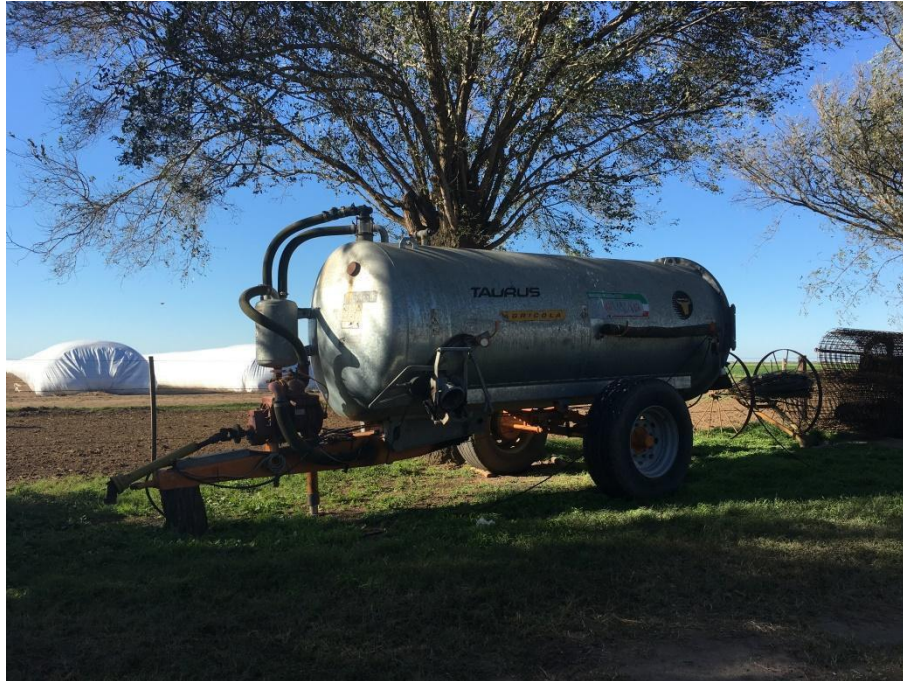
Figura 27. Estercolera para distribución de efluentes líquidos en tambo N° 4.
