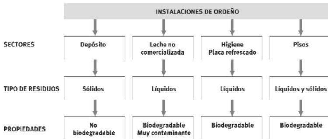
Figura 1. Clasificación de los residuos generados en las instalaciones de ordeño. Fuente: Charlón (2010).
