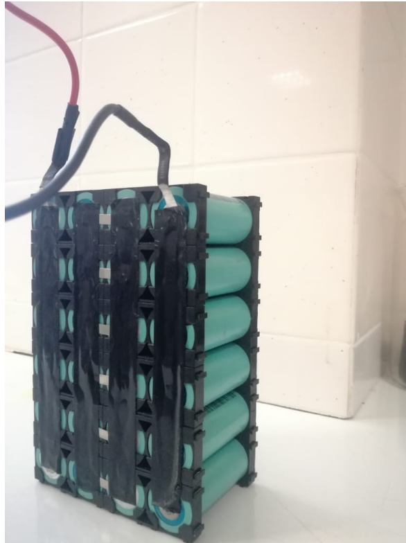
Figura 2.17: Paquete de batería de 24 celdas.
