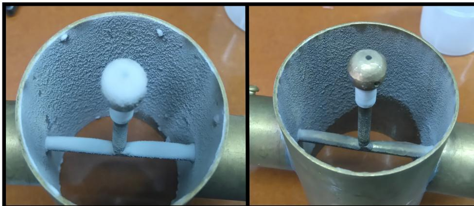
Figura 5.9: Fotografías del granizo luego de dos mediciones distintas. La imagen de la izquierda muestra el blanco recubierto con una acreción totalmente opaca mientras que la imagen de la derecha muestra al blanco recubierto con una acreción transparente.
