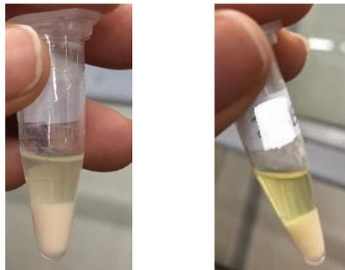
*Sueros con agregado de metanol grado HPLC, procesados con vortex y centrifugado.*
