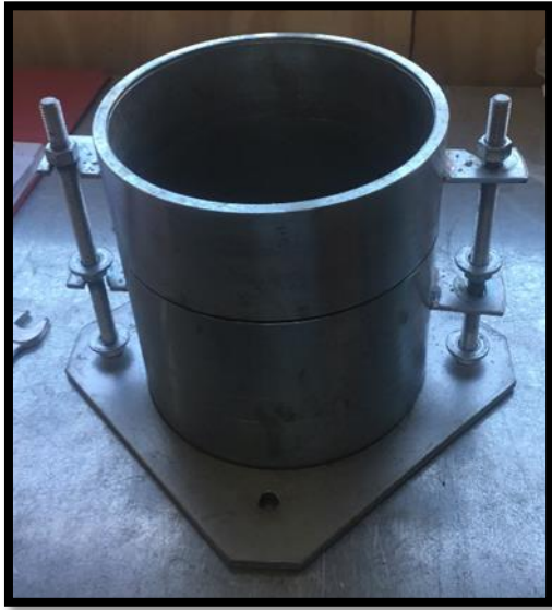
Imagen 4.5- Molde proctor Molde de 152,4 mm de diámetro
