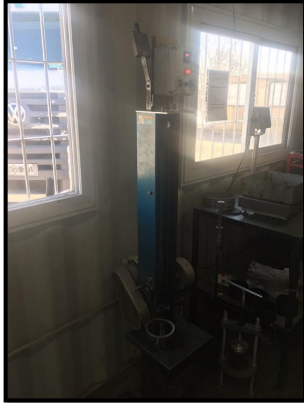
Imagen 4.16- Prensa automática para Ensayo Método Marshall
