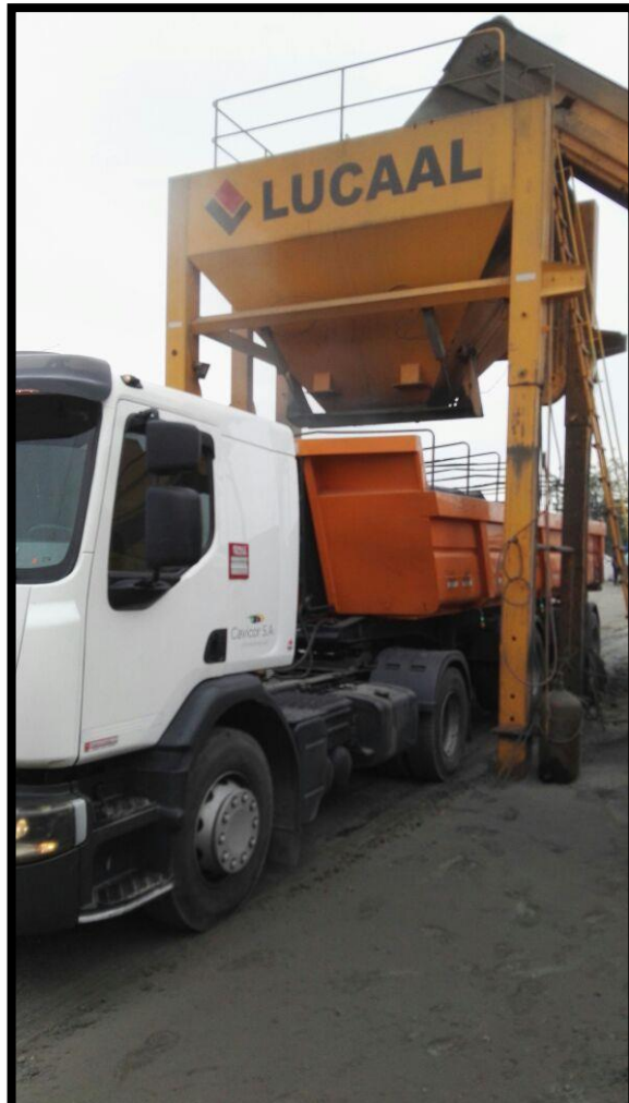
Imagen 3.2-Tolva de salida de mezcla asfáltica
