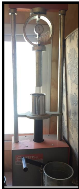
Imagen 4.7- Equipo para ensayo CBR o Valor soporte . Prensa, Moldes, Aro dinamo-métrico de 5000 KG.
