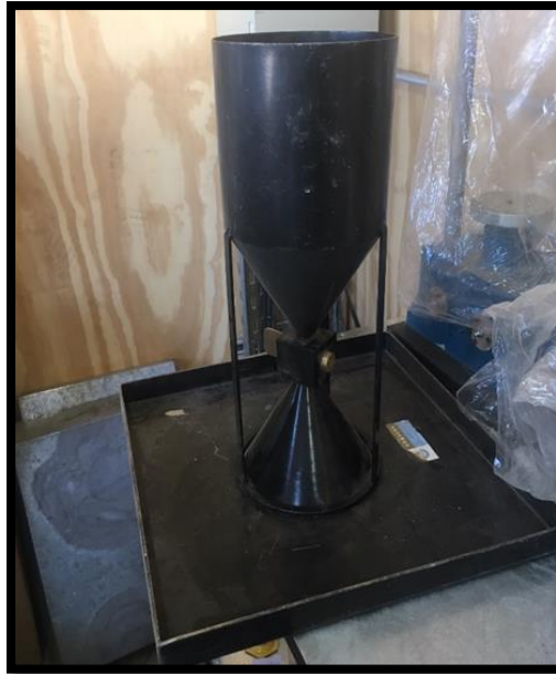
Imagen 4.11-Equipamiento control de compactación- Método control de densidad con cono de arena
