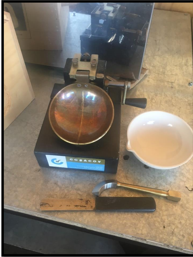
Imagen 4.1- Equipo de Casagrande para límite líquido de suelos, Acanalador, espátula y mortero de porcelana.
