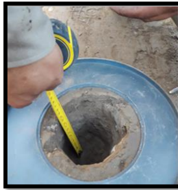
Imagen 4.12- Ensayo Método de la Arena. Medición de profundidad del pozo realizado en obra sobre capa a controlar.
