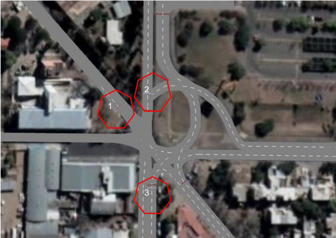
Figura 47, Captura de pantalla Vissim, ubicación de los contadores de cola en la red modelada.
