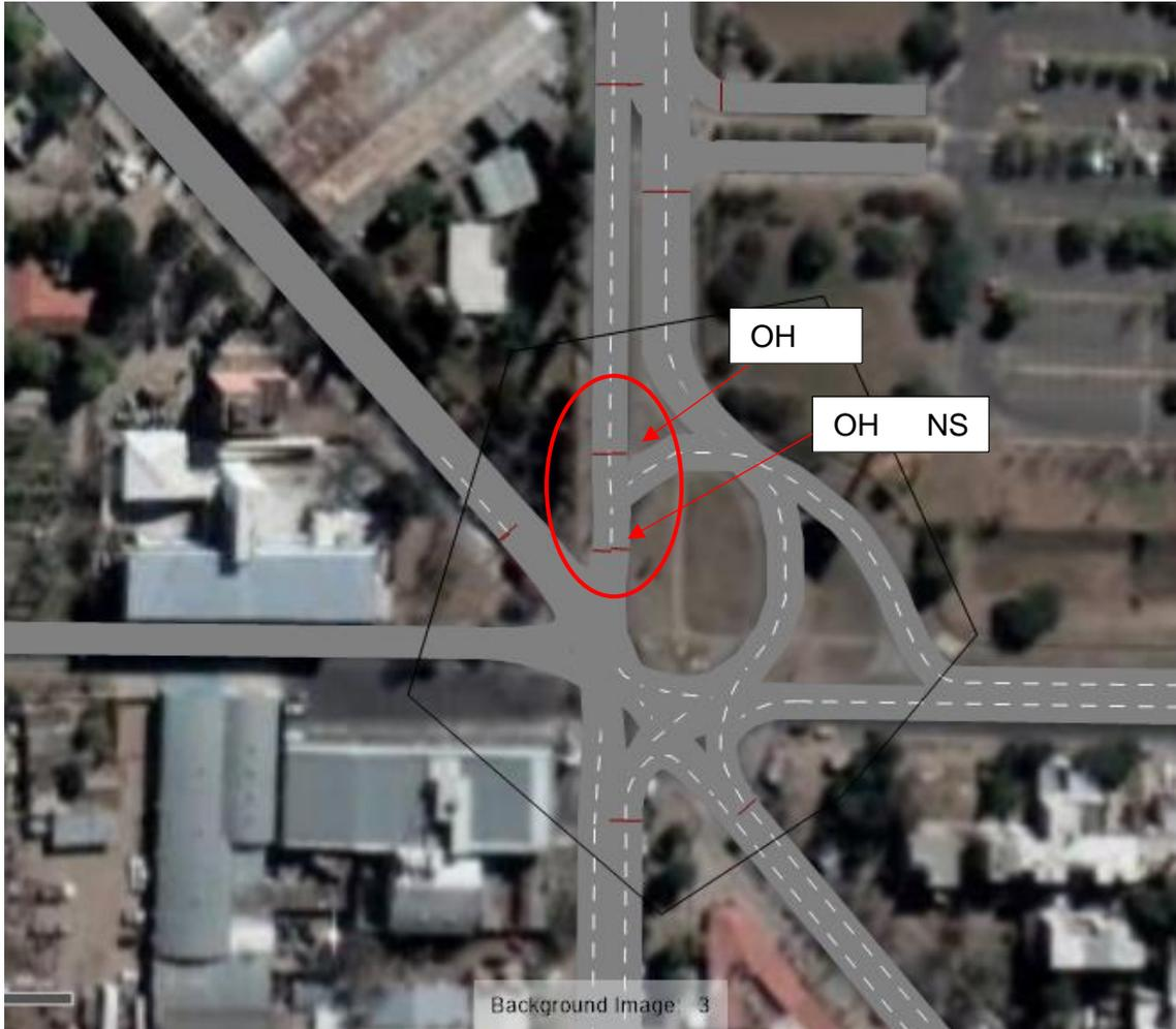
Figura 54, Captura de pantalla Vissim, detalle de los semáforos incorporados en alternativa 01
