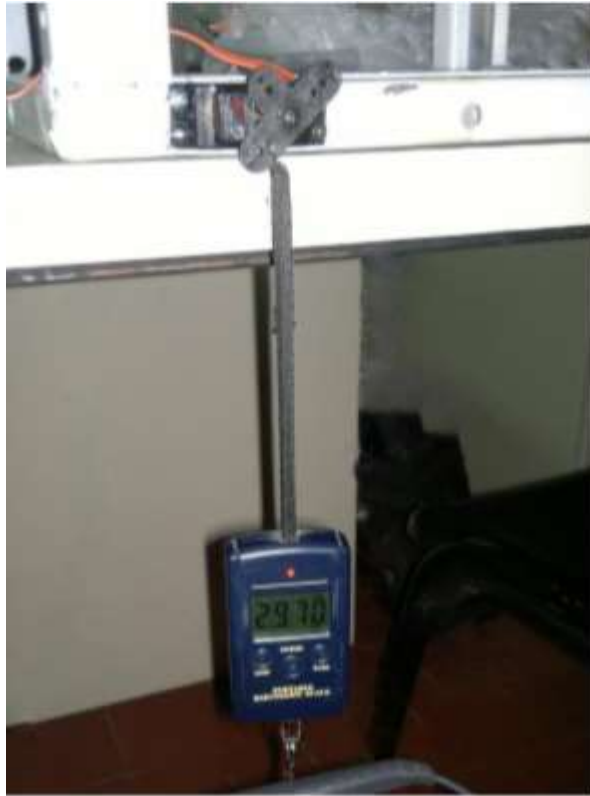
Figura 3.11.- Ensayo de Servomotor, sujeto a una carga. Fuente: Propia
