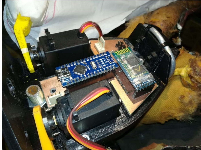
Figura 4.72.- Foto placa principal dentro del tórax del animatrónico. Fuente: Propia.
