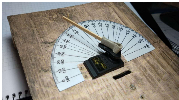
Figura 4.56.- Prueba de repetitividad de un servomotor con una IMU llevando de 0° a 60°. Fuente: Propia.
