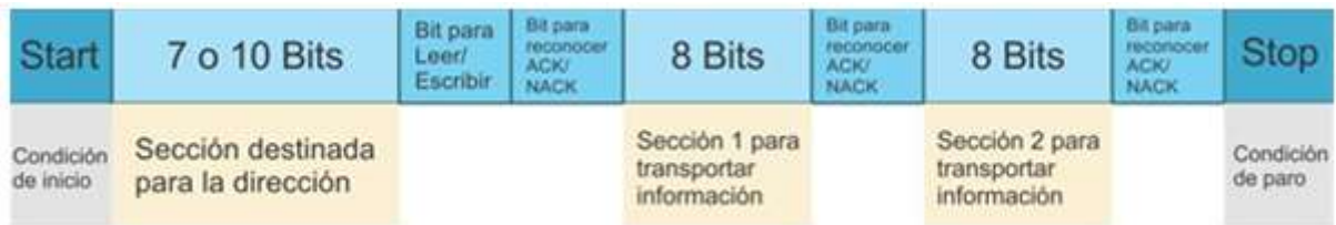
Figura 2.10.- Composición del mensaje enviado en protocolo I2C. Fuente: T-Bem [5]
