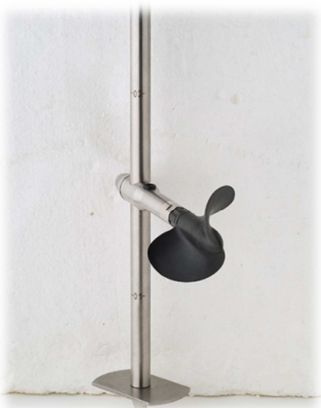
Figura 2.5. Molinete de eje horizontal.
