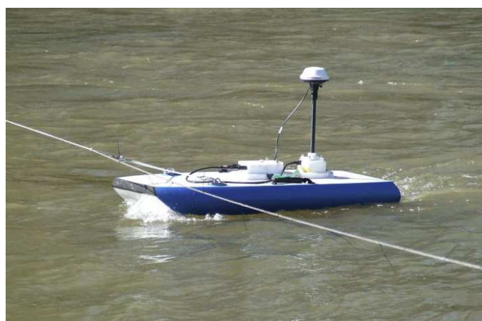
Figura 5.- ADCP RiverSurveyor S5 YSI/Sontek en campaña de aforo del río Tercero, en la localidad homónima.
