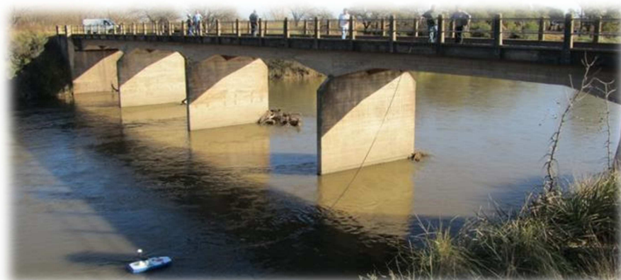
Figura 3.17. Medición sobre cursos anchos, remolcando el ADCP desde un puente.
