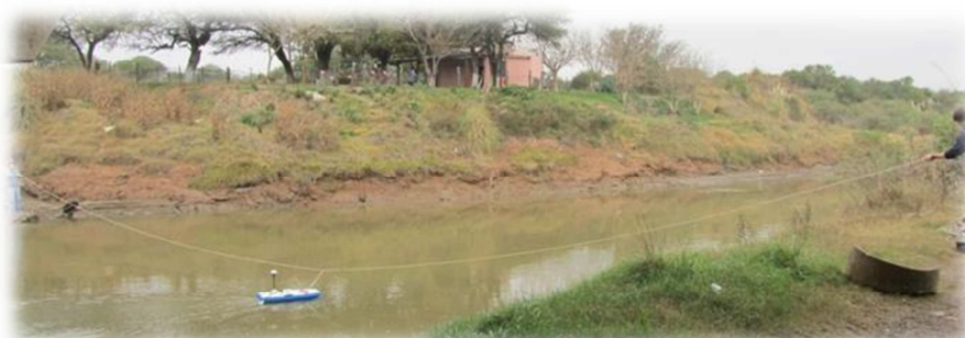
Figura 3.16. Medición sobre cursos angostos, remolcando el ADCP desde las orillas.
