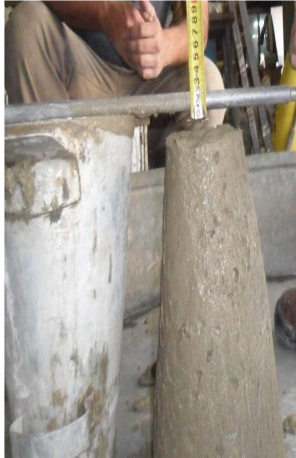
Figura 5.12 Asentamiento del hormigón según el cono de Abrams
