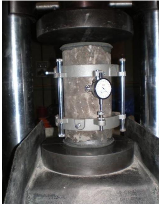
Figura 5.11 Ensayo para la determinación del módulo de elasticidad.
