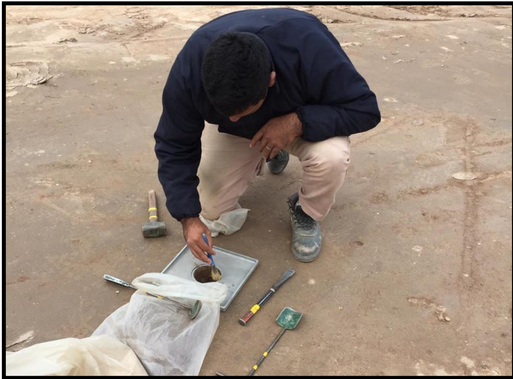
Figura 55. Ensayo de cono de arena en suelo arena.
