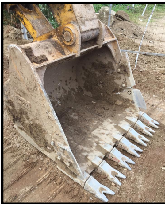
Figura 47. Balde de retroexcavadora con puntas dobles.
