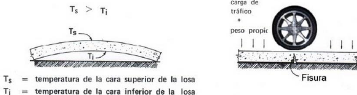
Imagen 63: Deformación de la losa durante el día, origen de la grieta por carga.
