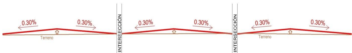
Imagen 55: Esquema que muestra la elevación de la rasante entre las bocacalles.
