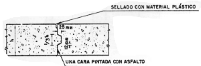
Imagen 68: Junta longitudinal ensamblada
