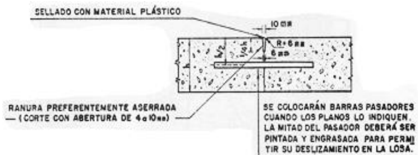
Imagen 68: Junta transversal de contracción
