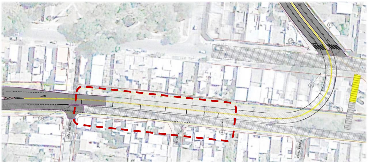
Imagen 73: Planimetría de demarcación donde se muestran las bandas sonoras indicando el comienzo de curva de radio reducido.
