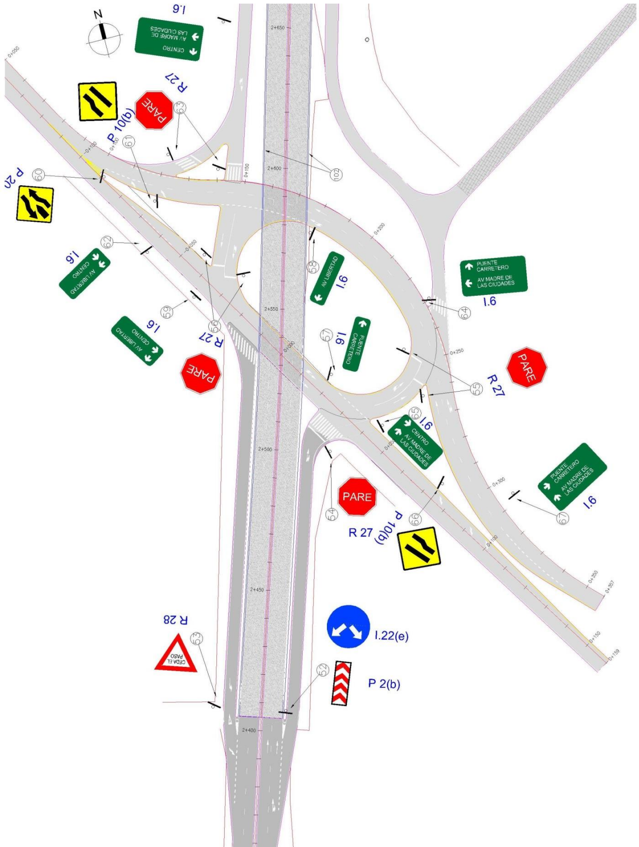
Imagen 84: Señalización y demarcación de Av. Lugones Norte intersección Av. Belgrano.
