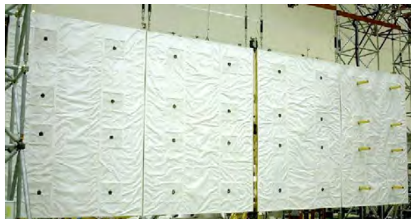
Figura 38: Antena de PALSAR durante una prueba de desarrollo. Fuente: Rosenqvist et al. (2004)
