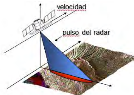
Figura 17: Adquisición de una imagen de radar. Fuente: Lopinto (2010)
