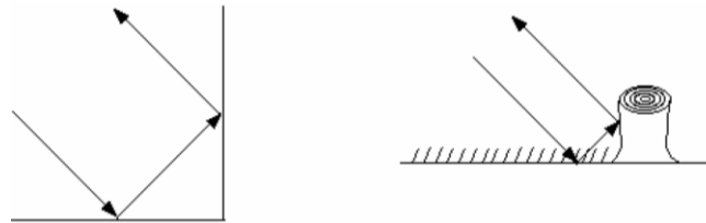
Figura 23: Mecanismos de dispersión: doble rebote. Fuente: SARMAP (2008)
