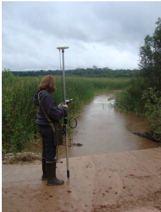
Figura 1. Registro de uno de los puntos de control terreno (GCP) con el rover del DGPS.
