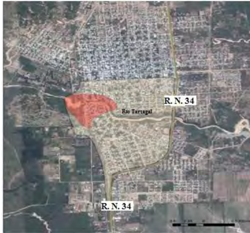
Figura 22. Superficies afectadas por el alud en la zona urbana de la ciudad de Tartagal sobre imagen satelital de Google Earth. El polígono rojo indica la zona más perturbada; el área en amarillo indica cuán lejos llegó el agua y el material sedimentado (Baumann et al. , 2009).
