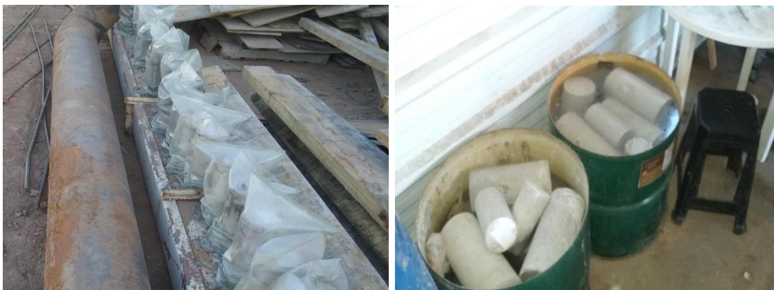
Figura 4.1.53: Acopio y control de curado de probetas de H°
