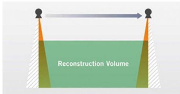
Figura 3.24 - Diagrama del Colimador activo. Se observa la exposición innecesaria a la radiación en el principio y el final de la longitud del escaneo (áreas rayadas).<sup>24</sup>
