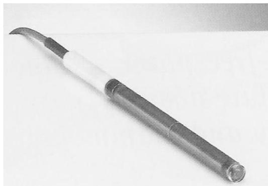
Figura 3.28 - Cámara de ionización tipo lápiz.<sup>28</sup>
