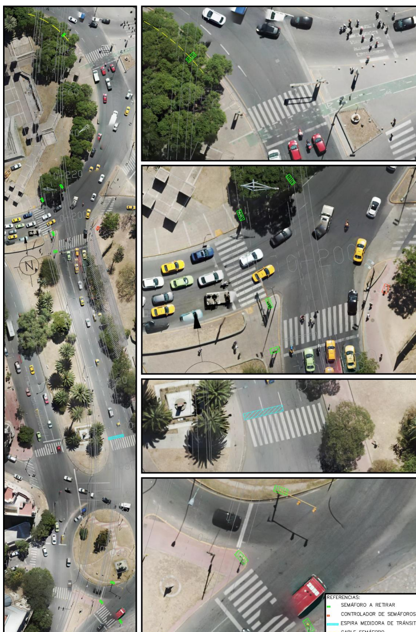
Fig. 3.11. Ubicación de semáforos existentes afectados (plano N°8).
