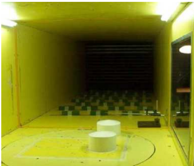
Figura 6: Ensayo en Túnel de Viento. J.L.Lassig, R.C.Jaca, C.Burgos, J.E.Cicerone, L.A.Godoy. Utilización del Túnel de Viento como herramienta para el análisis de tanques de petróleo en la Norpatagonia. Figura 9 pág. 10/16.
