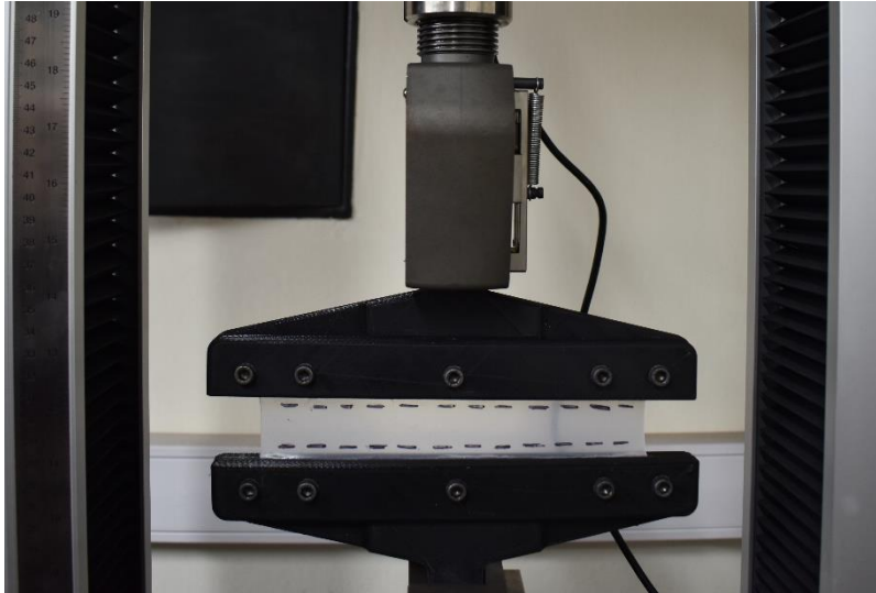
Ilustración 31: Dispositivo adaptador de mordaza para ensayo planar.
