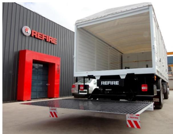
Ilustración 11: Plataforma autoelevadora de accionamiento hidráulico
