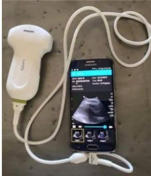
**Ilustración 8: Dispositivo de ultrasonido portátil con cable USB para smartphones o tablets**
