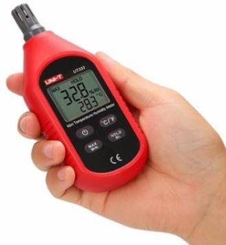
**Ilustración 31: Termohigrómetro utilizado durante la medición<sup>32</sup>**
