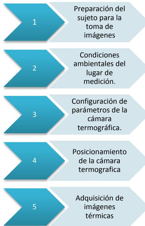
Ilustración 30: Esquema general del protocolo de adquisición de imágenes.<sup>31</sup>
