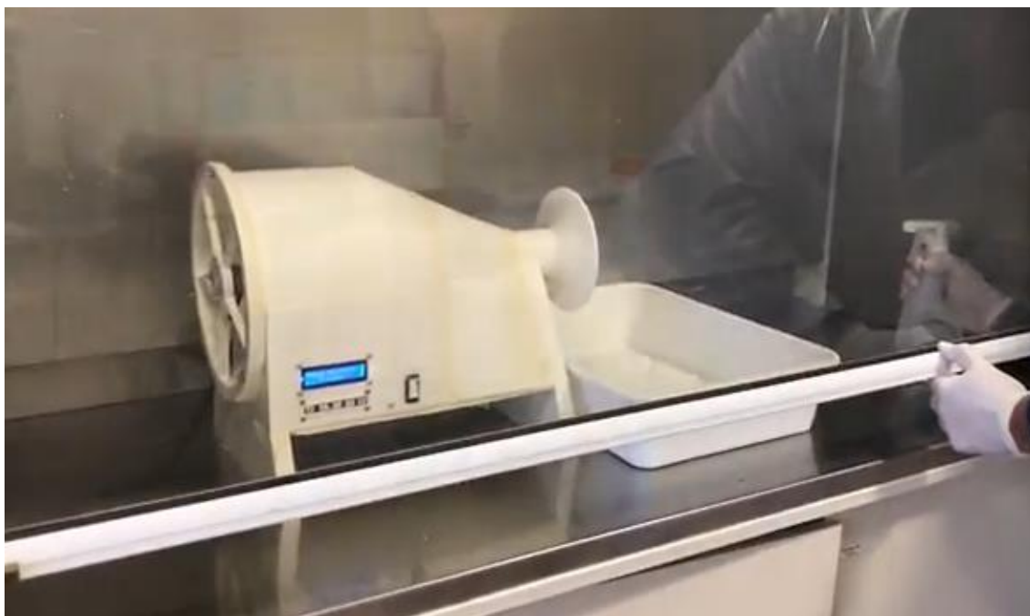
Figura 6. 51. Toma de la muestra durante el funcionamiento del prototipo (interior de la cámara).
