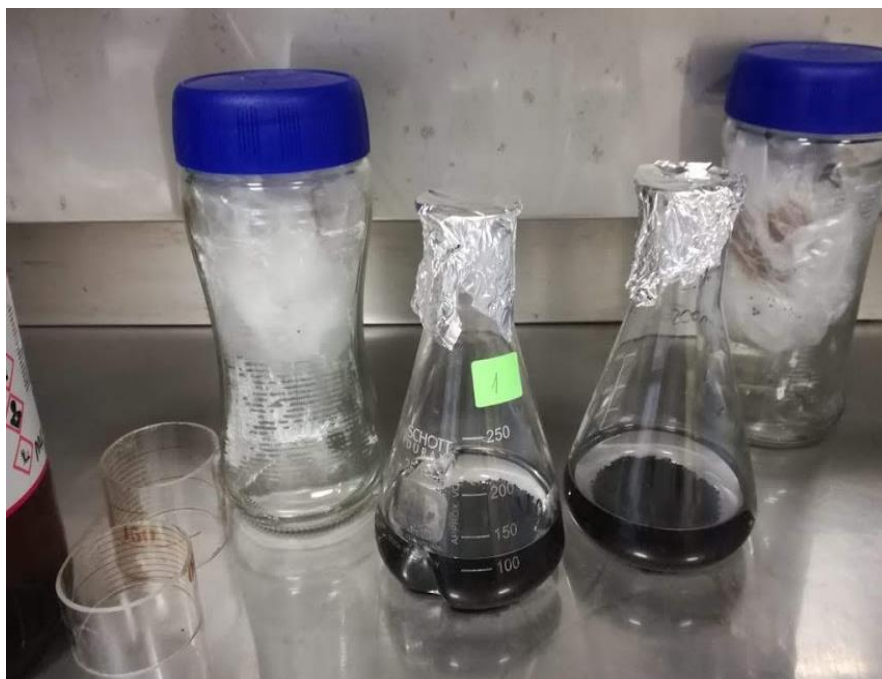
Figura 6. 54. Desorción de los compuestos activos retenidos en el carbón activado con n-hexano.
