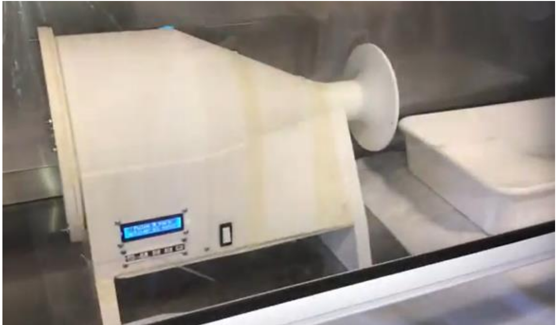
Figura 6. 49. Puesta en funcionamiento del prototipo de medición previo a la aplicación del plaguicida en la cámara.
