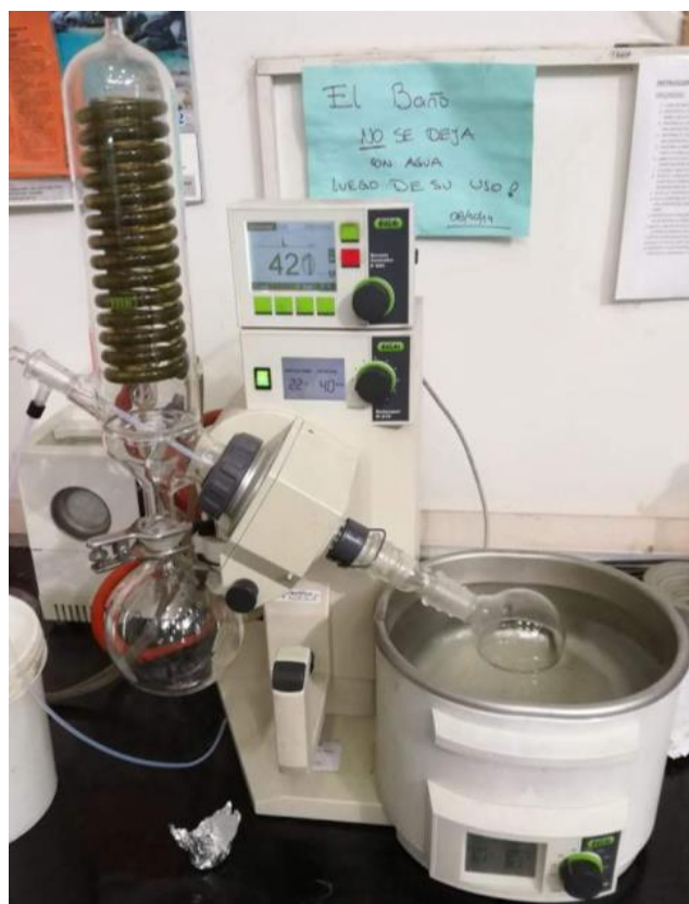
Figura 6. 55. Evaporador rotatorio con vacío para el proceso de concentración de la muestra.
