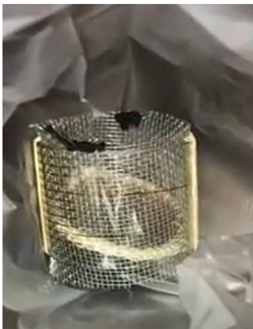
Figura 6. 47. Prototipo del tubo adsorbente en el interior de una bolsa de polietileno, para evitar la contaminación del material adsorbente.
